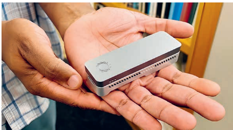
SLIKA 6.32. MinION uređaj za sekvenciranje se proizvodi u džepnom formatu (preuzeto s www.cshl.edu , pristup 29.7.2024.).
