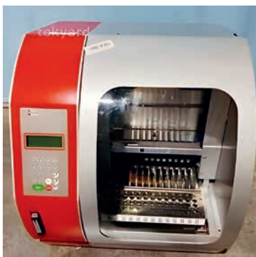
SLIKA 6.10. iPrep™ Purification Instrument od Invitrogena za automatsku DNA izolaciju (preuzeto i prilagođeno s https://www.medteh.info/_fr/66/IPrep_manual.pdf , pristup 3.10.2023.).
