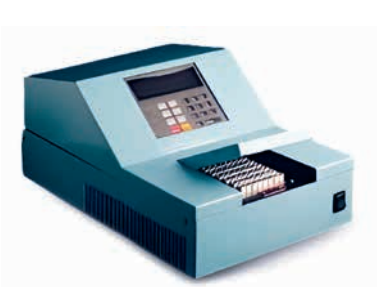
SLIKA 6.12. Prvi model zatvorenog PCR sustava proizveden 1986. godine, od milja nazvan Baby blue (preuzeto i prilagođeno s https://collection.sciencemuseumgroup.org.uk/objects/co146415/prototype-polymerase-chain-reaction-pcr-machine , pristup 28.7.2024.).
