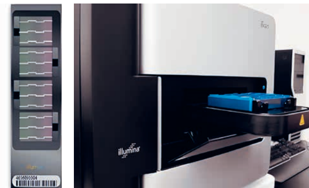
SLIKA 6.28. Primjer jednog bead -čipa korištenog za genotipizaciju te Illumina® genomski analizator (preuzeto i prilagođeno s www.illumina.com , pristup 3.10.2023.).
