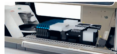
SLIKA 6.5. HID NIMBUS® Presto System za automatsku ekstrakciju DNA (preuzeto i prilagođeno s https://assets.thermofisher.com/TFS-Assets/GSD/Flyers/hidnp-flyer-ordering-table-global.pdf , pristup 3.10.2023.).
