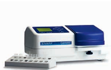
SLIKA 4.23. Spektrofotometrijski uređaj Genova Life Science Analyser – jedan je od uobičajenih sustava koji se koriste u spektrofotometrijskoj analizi DNA, RNK i proteina (preuzeto i prilagođeno s https://www.thomassci.com/Instruments/Spectrophotometers/_/GENOVA-LIFE-SCIENCE-ANALYZER , pristup 7.8.2024.).
