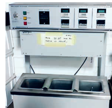
SLIKA 6.11. Izvedba preliminarnog PCR sustava koji je bio u upotrebi 80-ih godina prošlog stoljeća (preuzeto i prilagođeno s http://www.thermofisher.com/ , pristup 28.7.2024.).
